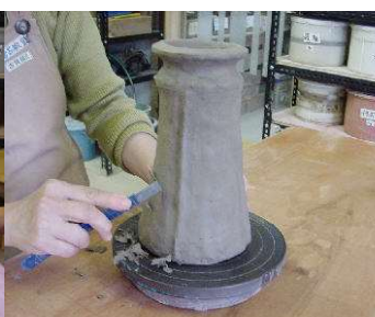
半乾燥後、凸凹をカンナで削る。
