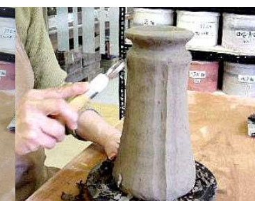
半乾燥後、凸凹をカンナで削る。
