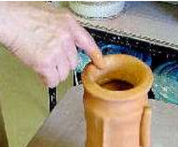
掛け残した指の部 分にも釉薬をつける。
