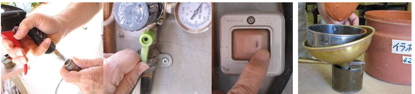
エアガンをノズルにセット。 緑のレバーを縦に、圧力0.2。 スイッチオン。 イラボ釉をフルイで漉して霧吹に。
