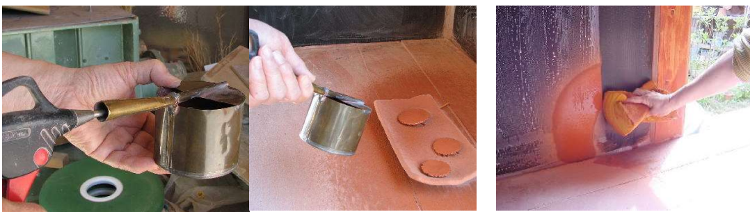
エアガンを霧吹にセットし、吹きかける。 スポンジで掃除。作品は酸化の棚へ。
