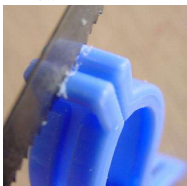
②溝を掘る
