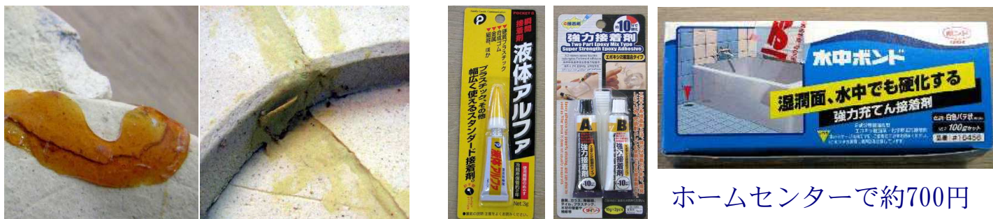
エポキシ接着剤の経年退色例。瞬間接着剤エポキシ接着剤、100円ショップで。
