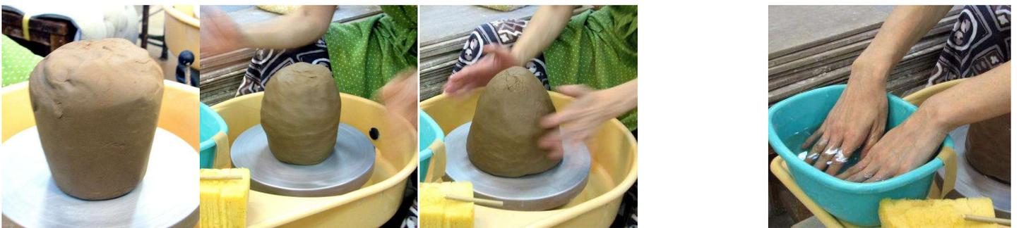
水をつけず、練手の右手側を下へ。斜め下中心に向けたたき、貼付ける。初めて手水。
