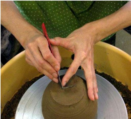
ロクロ削りもロクロ挽きと同様、各産地の伝統的な削り、道具、回転方向、利き手、などにより千差万別です。ここでは、湿台を使いし字カンナ、右回りで解説します。まず中心を取ることが基本になります。ある程度とれなければ、削り仕上げは出来ません。修得に個人差はありますが、繰り返し練習して下さい。
