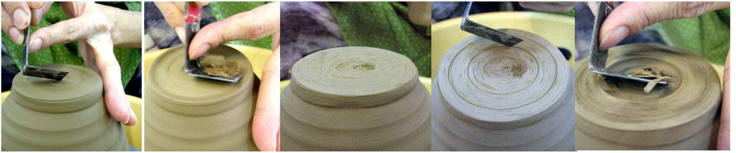
刃の角度注意。刃先を中心から外へ底面を水平に。高台マーク、中からケズル。
