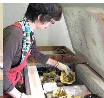
箱に詰め大切に持ち帰り 乾燥後素焼き800℃ 指定の色の釉掛 本焼1240℃で完成
