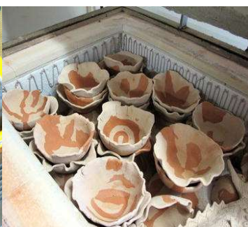
箱に詰め大切に持ち帰り 乾燥後素焼き800℃ 指定の色の釉掛 本焼1240℃で完成
