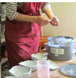
箱に詰め大切に持ち帰り 乾燥後素焼き800℃ 指定の色の釉掛 本焼1240℃で完成
