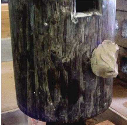
粘土でバランス調整。計量して同じ位置に同じ重さの鉛を打ち込む、鏡も同じ。
