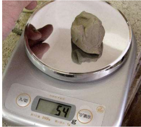
粘土でバランス調整。計量して同じ位置に同じ重さの鉛を打ち込む、鏡も同じ。
