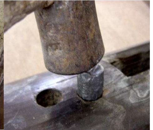
粘土でバランス調整。計量して同じ位置に同じ重さの鉛を打ち込む、鏡も同じ。
