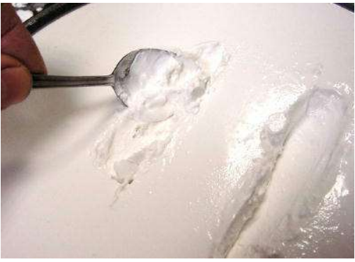
⑩半凝固で持ち手を掘る。 ⑪固まったらボールを外す。 ⑫ロクロに水を引き、摺り合わせ貼り付ける
