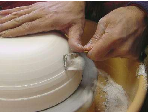
⑬超鋼カンナで蓋の合わせ目を削り出す。 ⑭濡れタオルをかぶせ一日乾燥しないよう養生。(24時間固まり続け丈夫になる)
