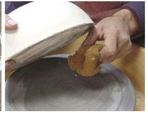
⑩半凝固で持ち手を掘る。 ⑪固まったらボールを外す。 ⑫ロクロに水を引き、摺り合わせ貼り付ける
