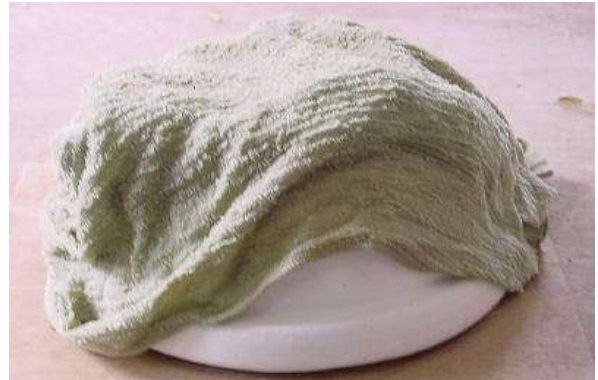
⑬超鋼カンナで蓋の合わせ目を削り出す。 ⑭濡れタオルをかぶせ一日乾燥しないよう養生。(24時間固まり続け丈夫になる)
