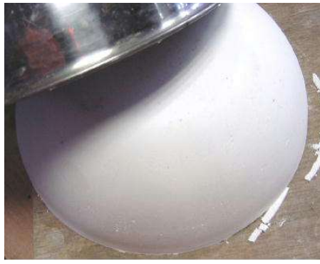
⑩半凝固で持ち手を掘る。 ⑪固まったらボールを外す。 ⑫ロクロに水を引き、摺り合わせ貼り付ける
