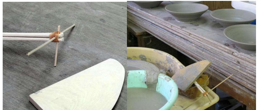
こてを使いロクロで試し引きし、微調整して完成。 ※見本の内径、内高寸法を1.17倍にしたトンボを使用。
